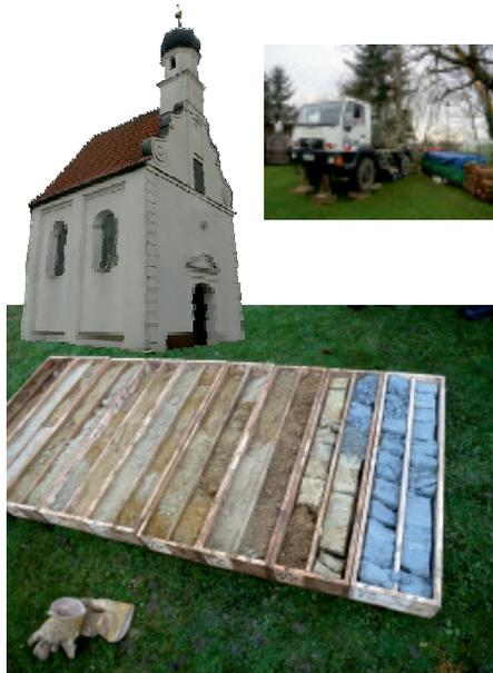
Die Peterskirche hat immer wieder kleine Risse. Deshalb wurden Sonden in den Berg eingeführt, damit nach der Untersuchung der Berg mit technischen Mitteln stabilisiert werden kann. Das große Bild zeigt die einzelnen Schichten im Bodenaufbau.
